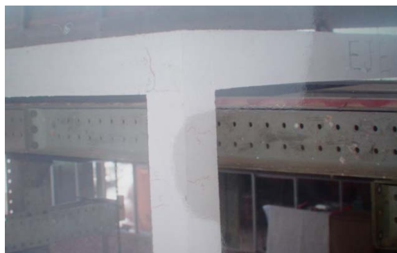
Fig.6. Nudos del nivel 1 y falla del aligerado con trituración de bloques.
