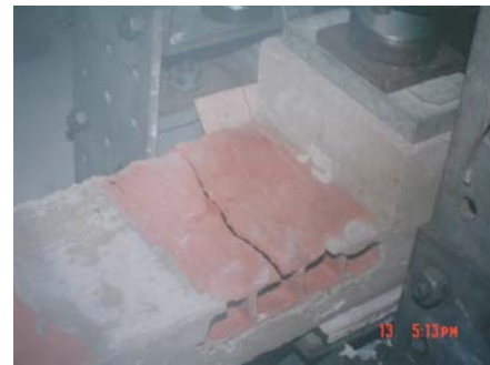
Fig.13. Ensayo de flexión de una parte del aligerado.
