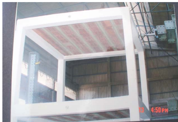
Fig.3. Ensayo estático para calcular la matriz [f] .
