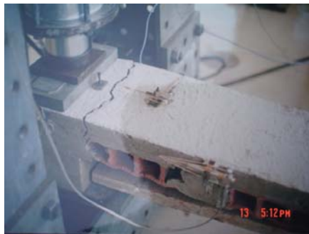
Fig.13. Ensayo de flexión de una parte del aligerado.
