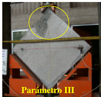
Fig.11 Falla local en muretes reforzados con malla.
