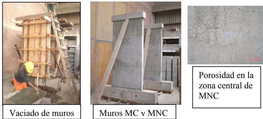
Fig.4 Secuencia seguida en la construcción de MC y MNC.
