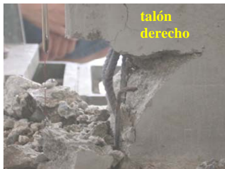
Estado del muro MC en la Fase 13, D1 = 27.5\text{mm}
