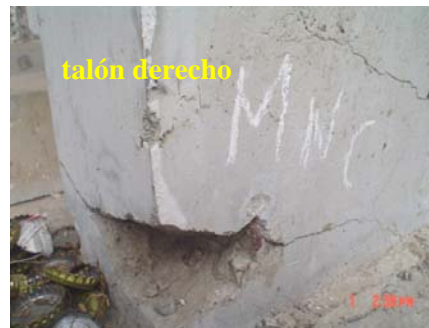
Estado del muro MNC en la Fase 15, D1 = 32.5\text{mm}
