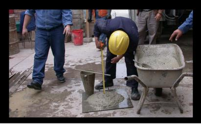
Concreto rheoplástico Slump = 10", f'c > 175 kg/cm<sup>2</sup>
