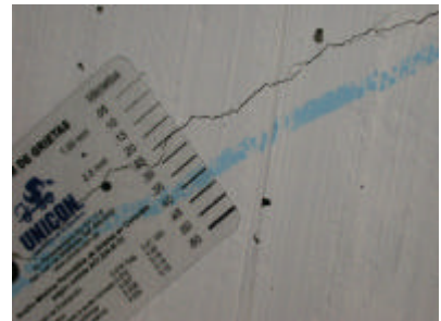
Foto 8. Vista global de los dispositivos (izquierda) y medición del grosor de fisuras (derecha).
