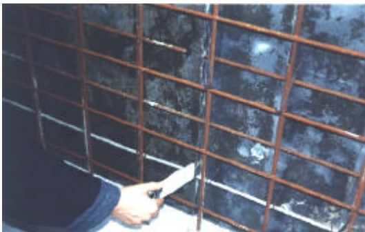
Foto 4. Corte del refuerzo horizontal en la franja de malla embutida en la cimentación de P1 (izquierda) y corbatas en la placa P2 (derecha).
