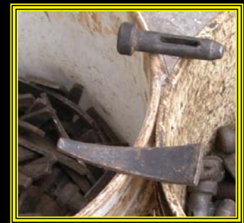
Conectores de tableros paralelos (corbatas en la unión de 2 tableros)
