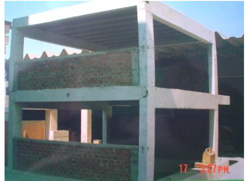
*Módulo Patrón antes y después del ensayo sísmico. Columnas fuera de plomo.*
