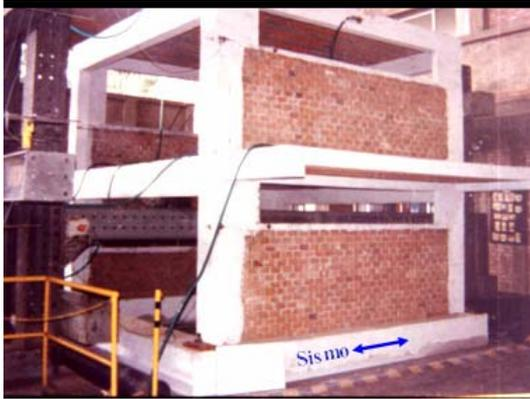
Foto 5. Módulo Reforzado después del ensayo.
