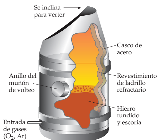
◀ Figura 23.6 Convertidor para la refinación del hierro. Se insufla una mezcla de oxígeno y argón a través del hierro fundido y la escoria. El calor generado por la oxidación de las impurezas mantiene la mezcla en estado de fusión. Cuando se alcanza la composición deseada, se inclina el convertidor para verter su contenido.
