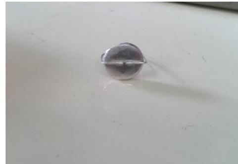
4. Se coloca la muestra en la canastilla y se introduce al ATG con una atmosfera de aire controlado de 40°C dentro del horno y 60°C la de la balanza, esto es regulado con nitrógeno líquido. Se revisa el peso y la temperatura.
