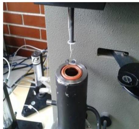
6. La computadora recaba los datos de cómo la muestra va perdiendo masa conforme aumenta la temperatura. Una vez alcanzada ésta temperatura se espera a que el horno se enfríe y se retiran los desechos.
